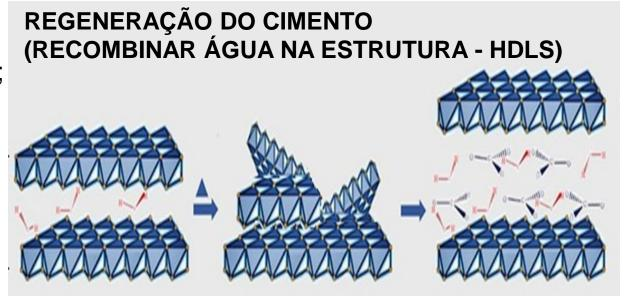
Desenvolver cimentos reciclados de elevada reatividade (endurecimento em até 12 horas) e de baixa pegada de carbono, para usos inovadores (captura de  $CO_2$ , impressão 3D).
